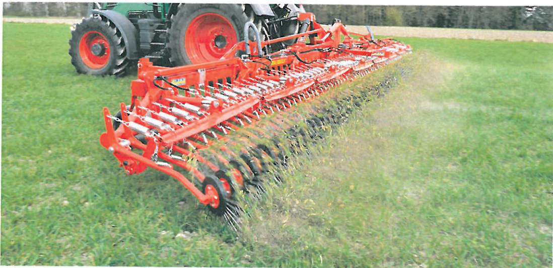
Tænderne på Aerostar Rotation er monteret på en roterende disk, der er skråtstillet, så de aggressive tænder renser inde i rækken. Tændernes aggressivitet kan reguleres hydraulisk fra traktoren til varierende forhold med jordtyper og afgrødestadie.
